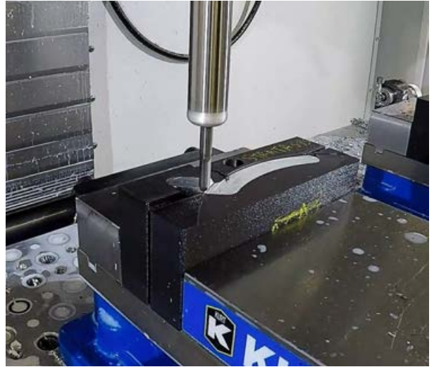
Mecanizado de una forma compleja mediante mordazas blandas de material compuesto FDM.
