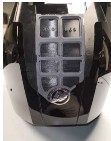
Accesorio de aplicación de accesorios FDM impresos en 3D que se muestra en la cubierta de un motor marino.
